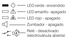
Fig. 3 - Estado "funcionamiento normal"
